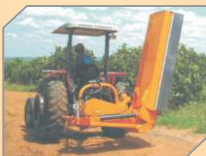
Posição de transporte e corte com ângulo positivo de até 90°.
