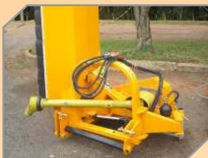
Cabeçalho de engate categoria II e III.
