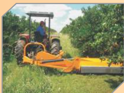
Deslocamento hidráulico super lateral.
