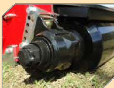
Rolo de apoio com sistema de mancal á óleo
