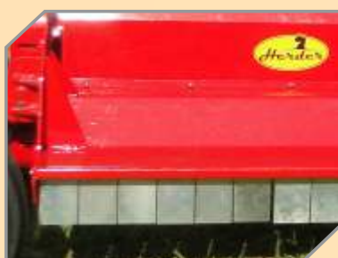
Aletas dianteira para proteção contra lançamento de objetos.
