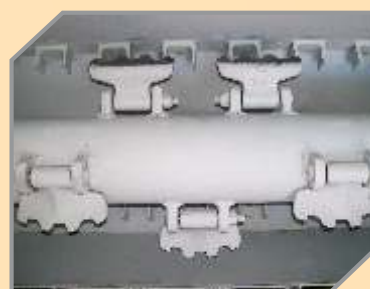
Martelos dentados para melhor trituração com contra facas internas.
