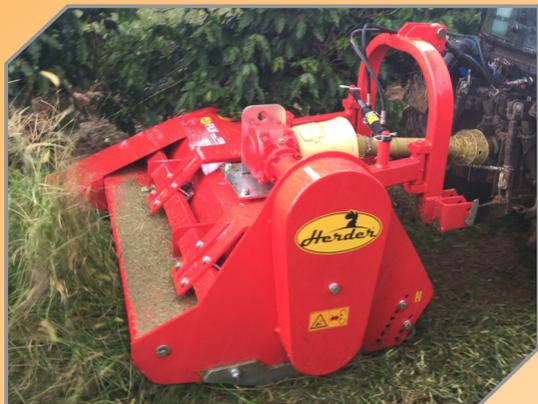
Rastelo hidráulico para arruação de café, em operação combinada com a trincha.
