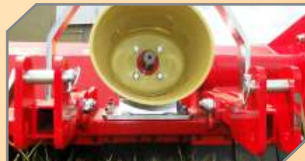
Exclusivo sistema de cabeçalho com 3 pontos de fixação, compatível com tratores Agrale 4100.
