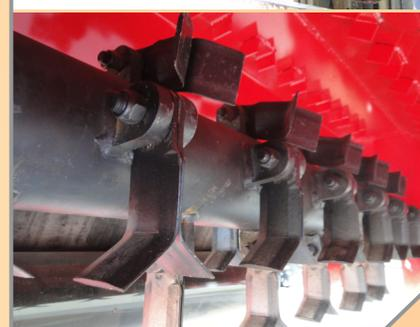
Corte através de martelos forjados de 1,3 kg. Opcional de sistema duplo de contra facas, com facas reversíveis e oscilantes com tratamento de superfície para maior durabilidade.
