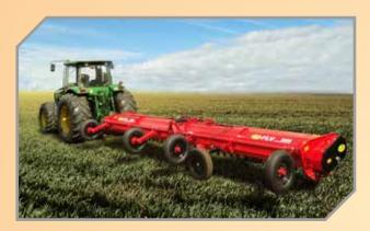
O sistema de reboque proporciona fácil transporte através de porteiras estreitas. Prático ajuste das rodas, para adaptar ao tipo de cultura.
